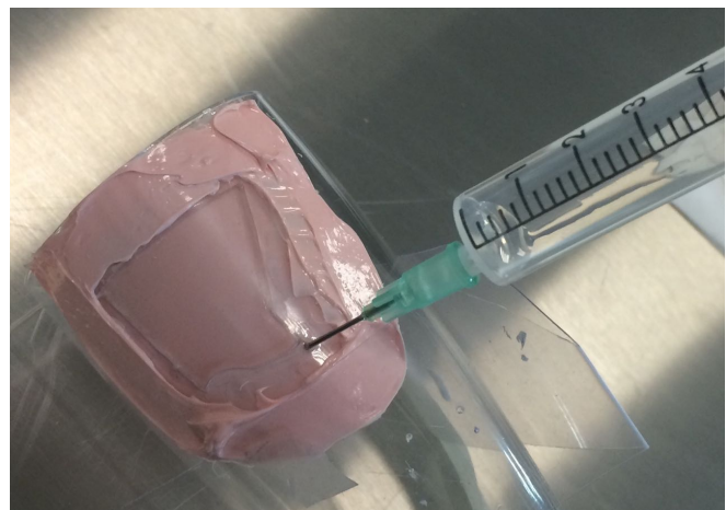
Injection de la résine dans le moule (Photo © G. Bussienne)
