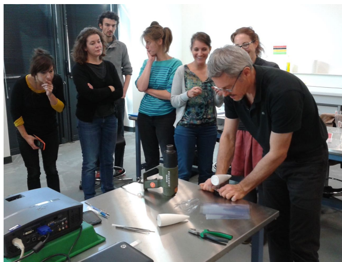
Gorazd Lemajič montrant la mise en forme de la feuille de PVC sur le moule en plâtre (Photo © INP)
